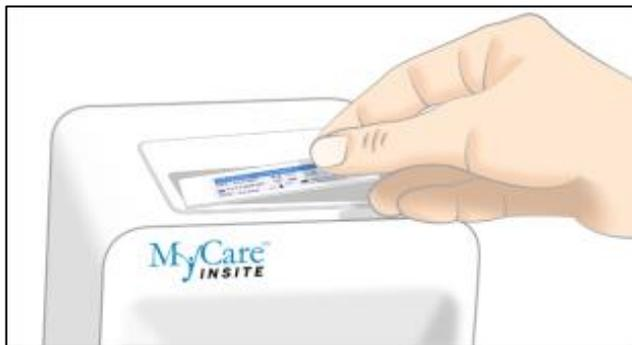
Estrarre la scheda RFID in dotazione dal kit di analisi e posizionarla nell'apposito pozzetto sulla parte superiore dell'analizzatore.
