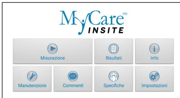
Per avviare una misurazione, selezionare
