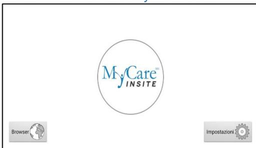
La schermata di avvio viene visualizzata premendo il pulsante Home del touch screen o quando il touch screen non è collegato all'analizzatore.
