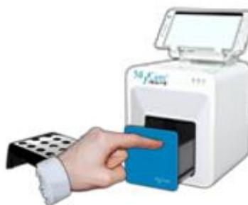
Al termine della misurazione, lo sportello si apre e il risultato viene visualizzato sul touch screen. Rimuovere la cartuccia di test e chiudere lo sportello per l'analisi successiva.
